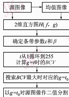
图 5 2 维 Otsu 改进算法流程 Fig. 5 The improved 2D Otsu procedure
